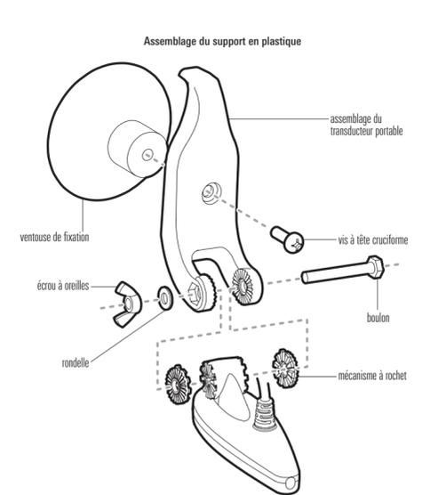
**REMARQUE** : Si vous ne pouvez encliqueter le transducteur afin qu'il repose au-dessous de la surface de l'eau, vous pouvez le démonter et aligner les denticules sur un numéro différent jusqu'à ce que vous atteigniez une position qui permette un alignement correct.
