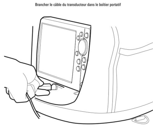
**Accessoire capteur de vitesse (vendu séparément)** : Si vous installez l'accessoire capteur de vitesse vendu séparément, insérez le connecteur du câble en Y du sonar dans le port de cavalier de la mallette de transport. Connectez ensuite le connecteur du transducteur et le connecteur du capteur de vitesse dans les connecteurs correspondants du câble en Y. Le câble en Y est vendu séparément. Contactez le support technique Humminbird pour obtenir plus d'informations.
